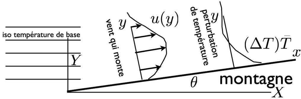
On va étudier l'écoulement dans le cadre de l'approximation de type "Boussinesq" en régime stationnaire. L'axe des  $x$  suit la pente de la montagne,  $y$  lui est perpendiculaire, alors que les axes  $X$  et  $Y$  correspondent respectivement à l'axe horizontal et vertical. L'angle  $(\vec{X}, \vec{x}) = (\vec{Y}, \vec{y})$  est noté  $\theta$ . Les équations vérifiées dans l'approximation de Boussinesq sont : (i) l'incompressibilité de l'air, (ii) le bilan de quantité de mouvement :
