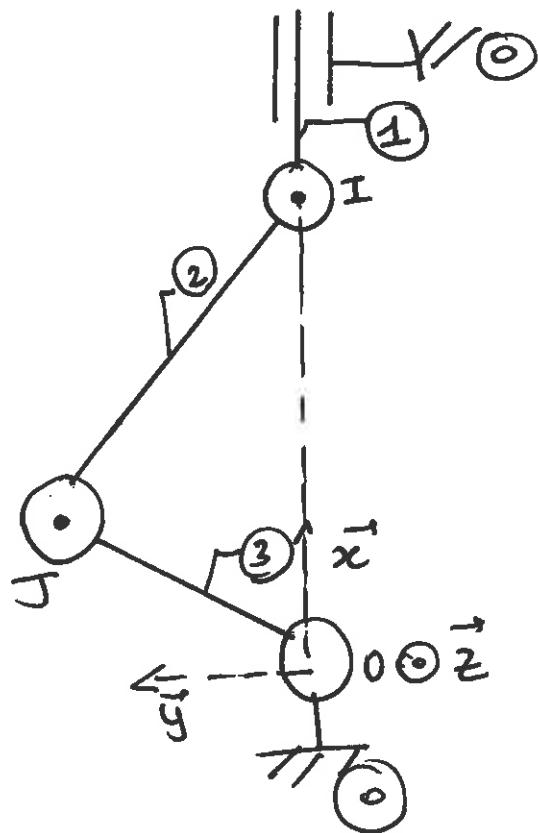
**A.** Le schéma cinématique ne doit pas respecter les échelles. En revanche il faut qu'il vérifie l'allignement des axes. Ici O et I sont alignés sur l'axe ( $O, \vec{x}$ )
