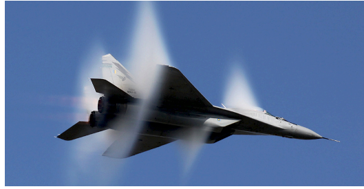
FIGURE 3 – Onde de choc se formant sur un Mig-29 rendue visible par la condensation de vapeur d'eau présente dans l'atmosphère.
