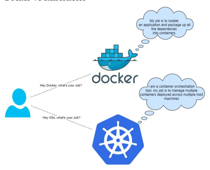
Docker est utilisé pour isoler votre application dans des conteneurs, tandis que Kubernetes est un outil de planification / orchestration de conteneurs et utilisé pour déployer et mettre à l'échelle votre application en gérant plusieurs conteneurs déployés sur plusieurs machines hôtes.
