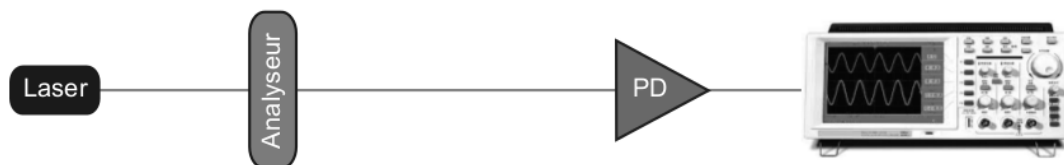
FIGURE 1 – Schéma du dispositif expérimental. PD : Photo-Détecteur.
